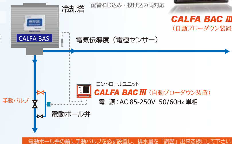
(電極センサー) 標準コード5m 配管ねじ込み・投げ込み両対応
