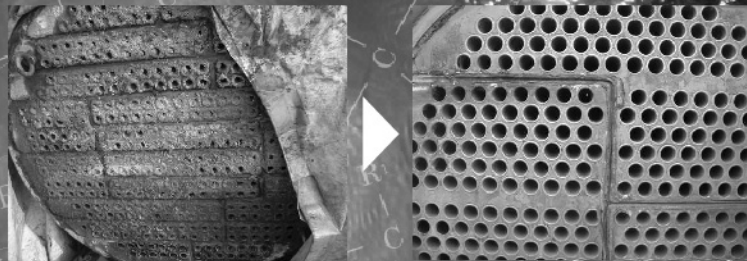
解放時に高圧洗浄、及びブラシ等は一切使用していない。
