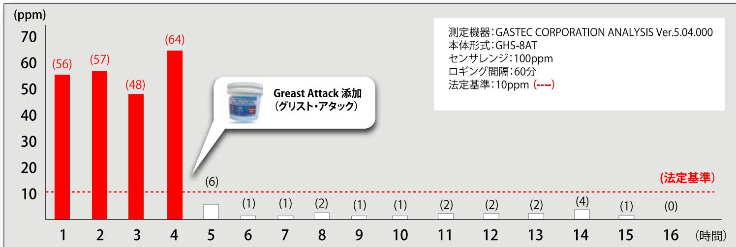
「硫化水素」を発するのは主に「有機物腐敗汚泥（スカム）」です。 Great Attack (グリスト・アタック) はスカムと混ざると瞬間に「硫化水素」を分解しますので、ほぼ無臭の固体として物理的に清掃処理しやすくなります。
